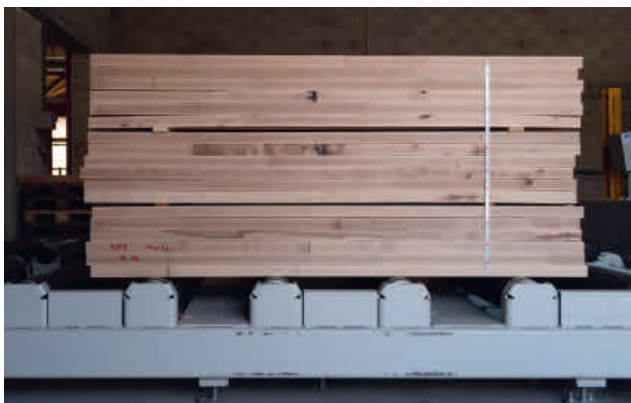
Nach Festigkeit sortierte und auf Feuchtigkeit geprüfte Kanthölzer auf dem Weg zur weiteren Verarbeitung
